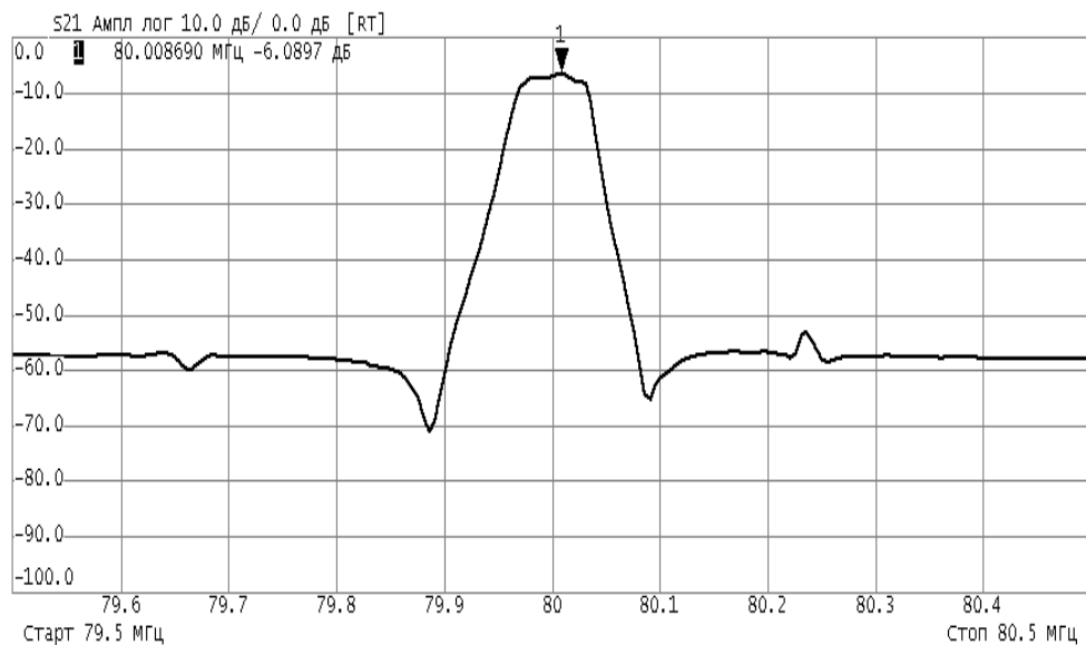
Рис. 4 АЧХ двухкаскадного сверхузкополосного фильтра на ПАВ с f_0 = 80 МГц, полосой пропускания \Delta f = 59 кГц по уровню -2 дБ ( \Delta f/f_0 = 0,073 %), вносимыми потерями 5,9 дБ с LC-согласованием и затуханием в полосе задерживания 50 дБ
